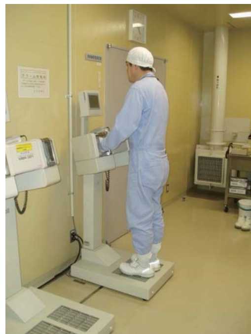
管理区域の出入管理(汚染検査)
