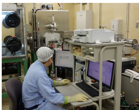
質量分析法による同位体組成の測定 (東海保障措置分析所)
