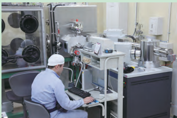
質量分析法によるプルトニウム同位体組成の測定
