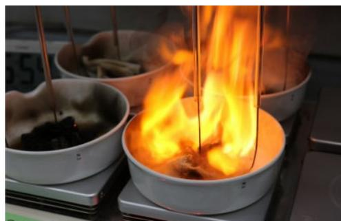
写真4. ナトレックス M、硝酸、塩酸ヒドロキシルアミン混合系(加熱系およそ 160℃)における発火
