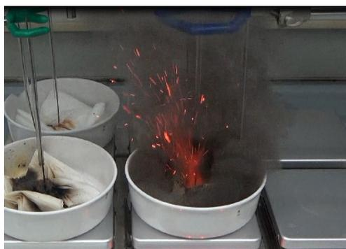
写真 1. ナトレックス M、硝酸、アスコルビン酸、塩酸ヒドロキシルアミン混合系(加熱系、およそ 140°C と推定)における発火
