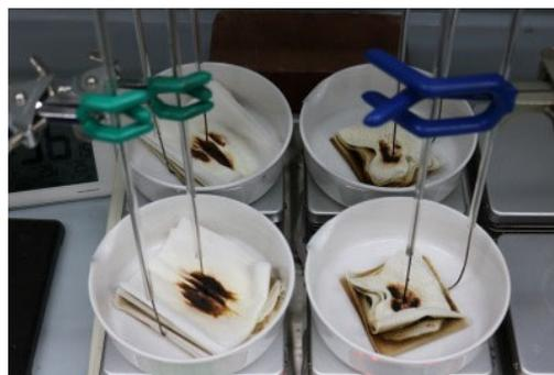
写真 2. 硝酸、アスコルビン酸、塩酸ヒドロキシルアミン混合系(ナトレックス M 無し、加熱系およそ 230°C 保持)における焦げ(発火なし)
