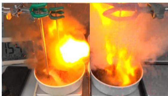
写真3. ナトレックス M、硝酸、アスコルビン酸混合系(加熱系およそ 140℃)における発火
