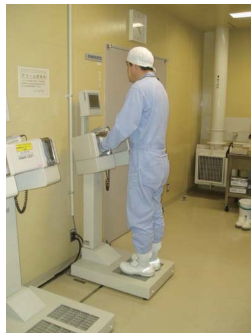
管理区域の出入管理(汚染検査)
